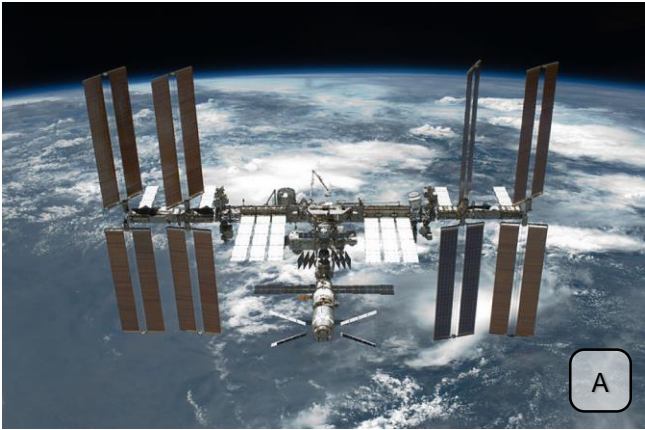
GAMBAR 3 : (A) Foto dari the International Space Station (ISS) di orbit sekitar Bumi. ISS memiliki dimensi 110m x 74m x 30m (p x l x t) dan massa total 400 ton. Operasi otomatisnya didukung oleh delapan generator Matahari. Tiap generator terdiri atas sebuah pilar yang dikelilingi dua permukaan 32m x 11m yang menyokong sel-sel photovoltaic. (B) Kubah yang mensimulasikan hidup di Mars selama program HI-SEAS yang dilaksanakan di kemiringan gunung api Kilauea di Hawaii. Kondisi-kondisi kehidupan dan kebutuhan energi untuk kegiatan otonom (yang terpenting tekanan dan pemanasan) bagi modul kolonisasi Mars sama dengan di ISS.
